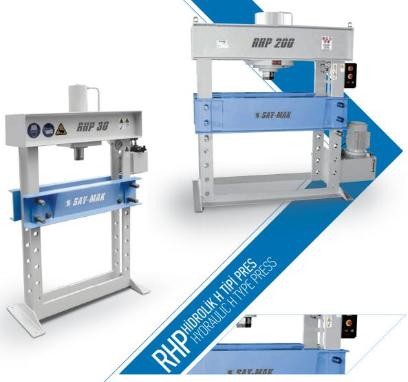
Kaynaklı çelik konstrüksiyon gövde Basınç göstergesi Aşırı yüklenmelere karşı emniyet valfi Ayarlanabilir alt tablalar Tabla kaldırma tertibatı Hızlı aşağı iniş, iş üzerinde yavaşlama Selenoid kontrol sistemi (opsiyonel) Ayarlanabilir basınç Gezer Silindir (Opsiyonel)
